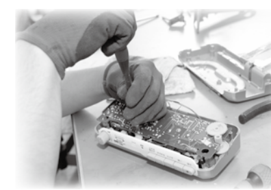
▲回収された小型家電は、一つずつ手作業で分解していきまます
