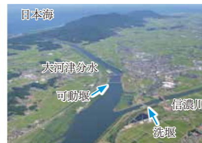
▲通水して以来、越後平野を信濃川の洪水から守っている大河津分水。
