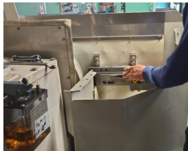
▲ナイフの自動研削工程
