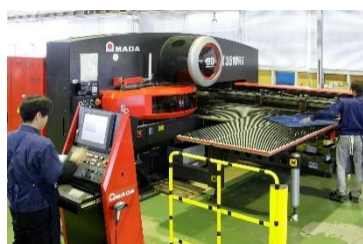
タレットパンチプレスと呼ばれる機械で1枚の板を型で抜いていく。その後、その金属板をロールやプレス、ベンダーといわれる機械で曲げてカタチにしていく。
