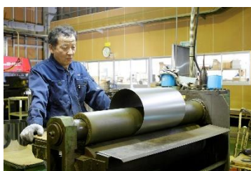
タレットパンチプレスと呼ばれる機械で1枚の板を型で抜いていく。その後、その金属板をロールやプレス、ベンダーといわれる機械で曲げてカタチにしていく。
