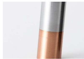
摩擦圧接加工による異素材の溶接
