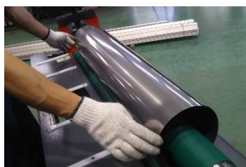
加工によるキズを最小限に抑えるウレタンロール加工機
