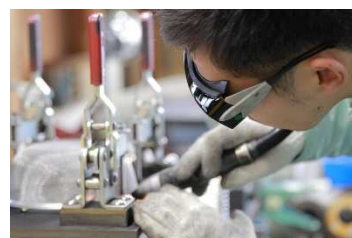
レーザー溶接機を使い、薄い物でも歪みを抑えた溶接が可能
