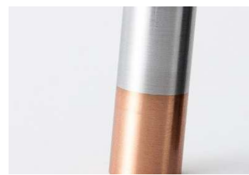
摩擦圧接加工による異素材の溶接
