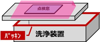
フタ部分や点検窓のパッキン等の定期的な交換。こまめなフタの開け閉め。点検窓はビニールシートを設置するなどの工夫ですき間からの漏れ出しを防止
