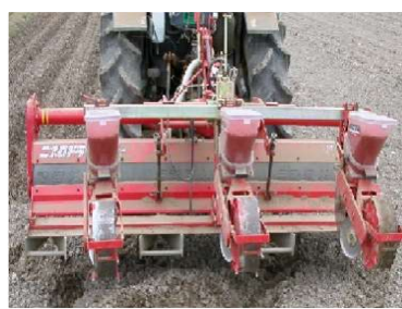
◀ ドライブローリーに排土板を装着
