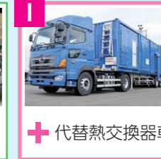
残留熱除去設備 (各号機3台)
