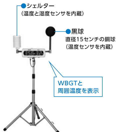
図2 WBGT測定装置 (リアルタイムでWBGTと周囲温度が表示される)
