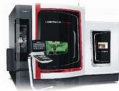
▲アディティブマニファクチャリング機能を組み込んだ加工機
