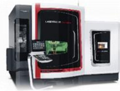
▲アディティブマニュファクチャリング機能を組み込んだ加工機
