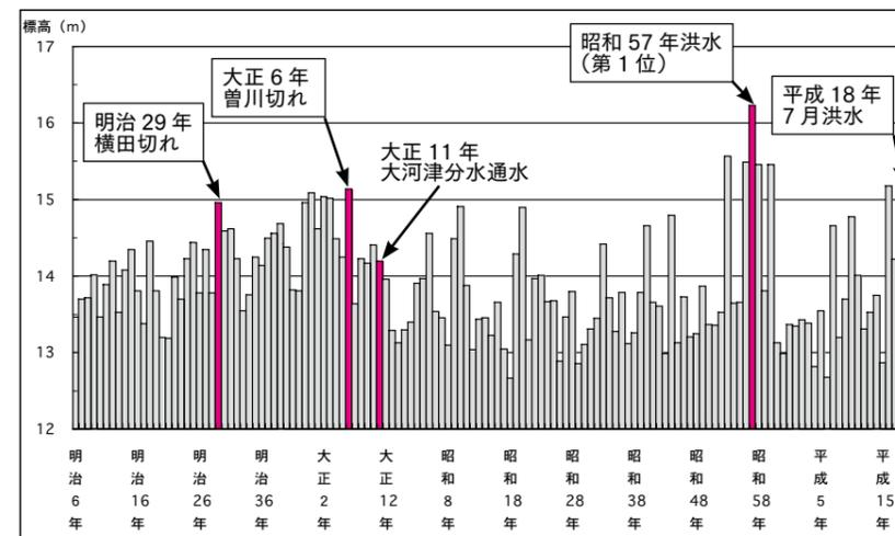
↑大河津分水路の通水後も信濃川では大洪水が発生していますが、信濃川下流域（分水より下流・新潟方面）では、洪水が信濃川の堤防を越えたり破堤による水害は発生していません。（グラフは大河津地点における年最高水位）
