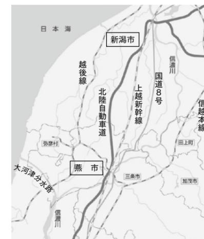
↑洪水氾濫の心配が無くなったことから、上越新幹線や北陸自動車道などが越後平野の中心を通るようになりました。大河津分水路建設前からある信越本線・越後線は、洪水による被害が少なくなるように、山ぎわを通過していたことがわかります。
