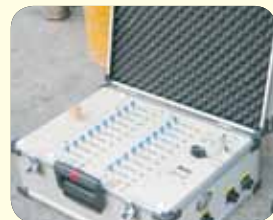
▲電気での点火装置 この装置から花火へ電線をつなぎ、電気で点火します。
