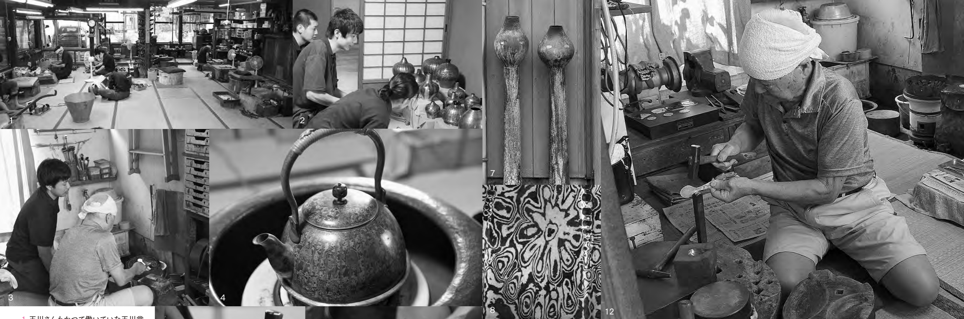
1 玉川さんもかつて働いていた玉川堂の作業場の様子 / 2 玉川さんの作品を覗き込む職人 / 3 若手職人に技術を伝える玉川さん / 4 自宅で愛用している薬罐 / 5・6 金鍔、木槌で成形する様子。写真5で器を引っ掛けているのが鳥口 / 7 若い頃に製作した思い出の作品 / 8 木目金の斑紋模様 / 9 数種類の金属板を重ね溶着した木目金の元となる塊 / 10 写真9の塊を機械ハンマーで打ち延ばし、木目の模様を出したもの / 11 つばめっ子かるたでも紹介されています / 12 自宅の工房にて作業する玉川さん
